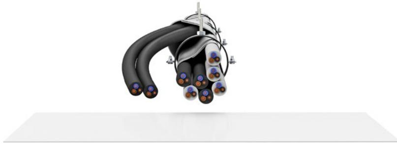
2. Herausgeführte Kabel auf einer Länge von  $\geq 300$  mm umwickeln (beschichtete Seite nach innen).
