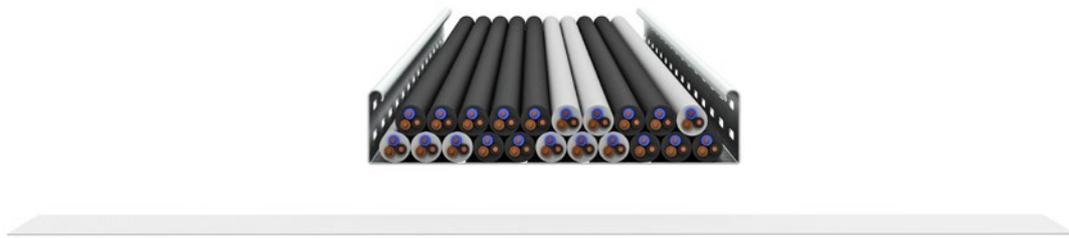
2. Außenlage des Brandschutzgewebes mit 50 mm Überlappung auflegen (beschichtete Seite innen).
